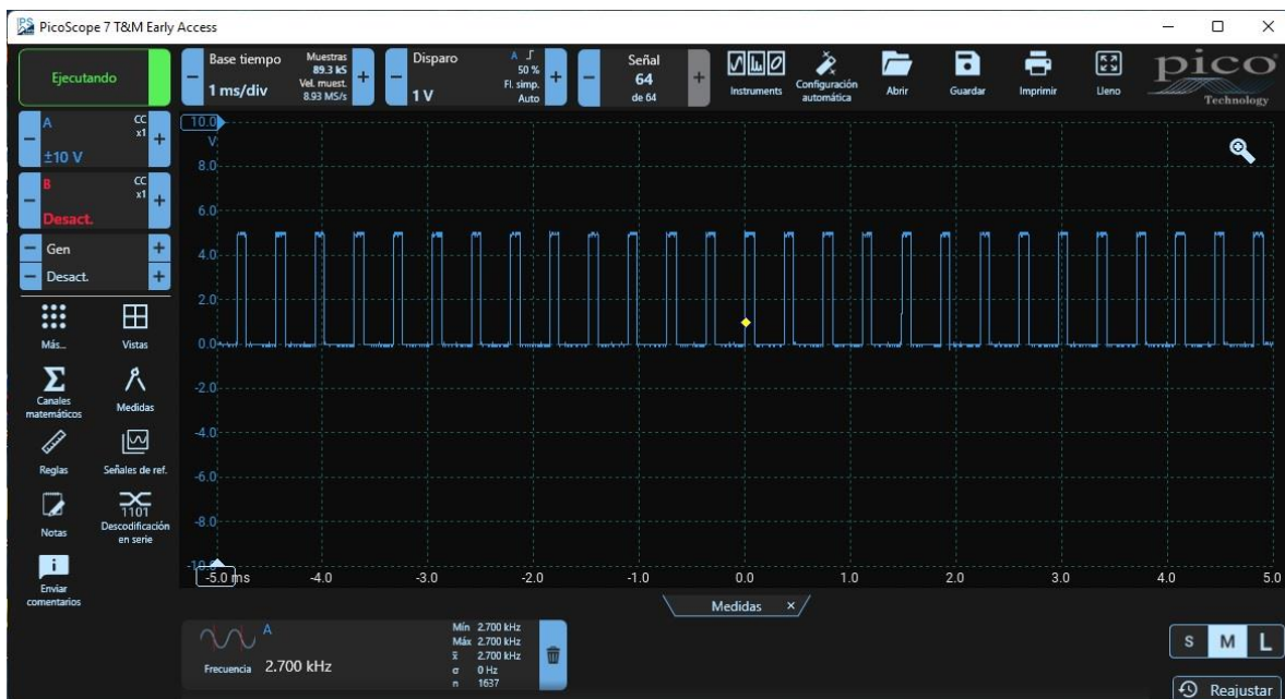
Figura 20: Medición de frecuencia con osciloscopio.
