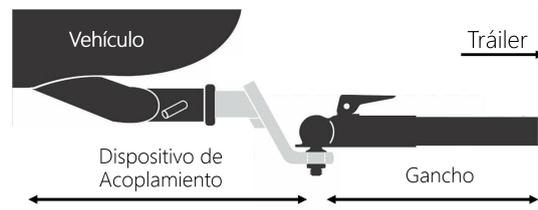
Figura 2.2: Acoplamiento entre vehículo y tráiler a través de un gancho convencional.
