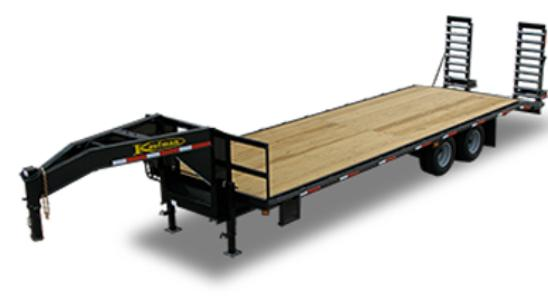
(d) Tráiler convencionalmente usado para un gancho tipo *Gooseneck*.
