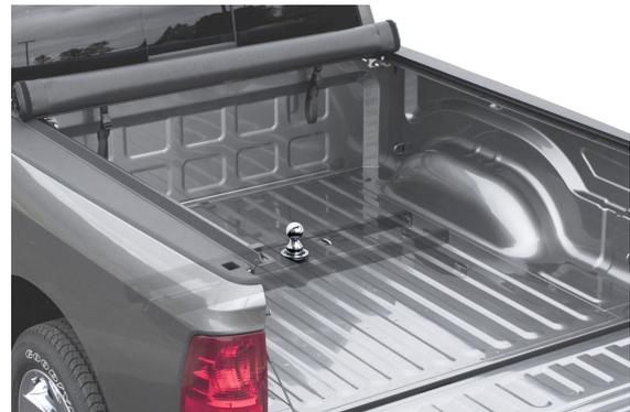
(b) Dispositivo de acoplamiento para gancho *Gooseneck*.
