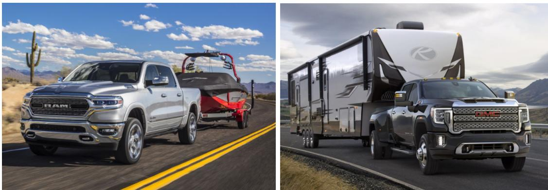
(a) *RAM 1500 Light Duty* capacidad 5780 kg con gancho tipo convencional. (b) *GMC Sierra Heavy Duty* capacidad 9070 kg con gancho tipo *5th Wheel*.
