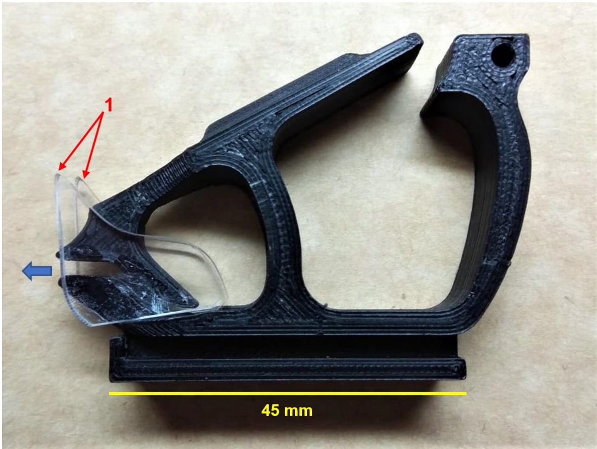
Figura 68. Prototipo experimental final del mecanismo flexible de pinzas. 1) Paredes de acrílico de 2 [mm] de espesor. La flecha azul representa la dirección de salida del flujo.
