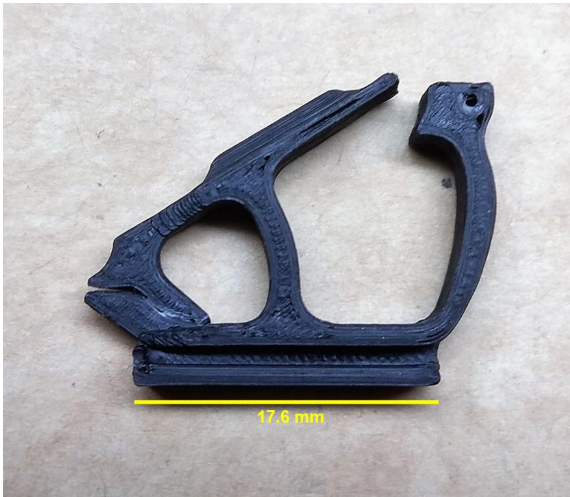
Figura 69. Prototipo experimental reducido a un 30% del tamaño del diseño definitivo del mecanismo flexible de pinzas.
