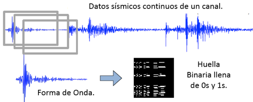
Figura 17. Esquema general de etapa de extracción de características. Adaptada de la guía de usuario de FAST.
