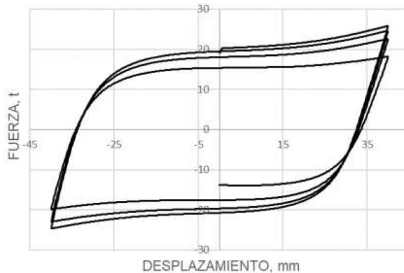
Figura 3.7. Curva carga-desplazamiento prueba fatiga (Instituto de Ingeniería, 2019)
