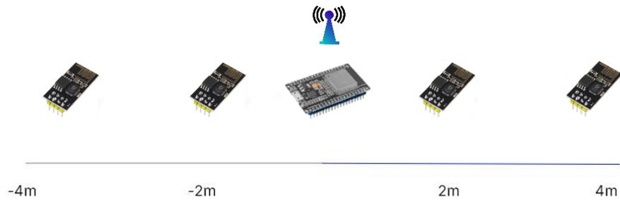
Fig. 16 Figura ilustrativa de cómo se colocaron los receptores de señal y el *Access point* para esta prueba
