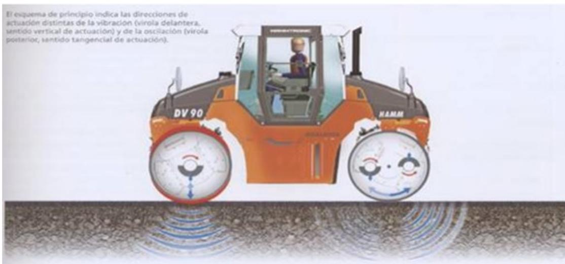
Fig.III.1.4 Esquema del compactador HAMM vibratorio / oscilatorio.
