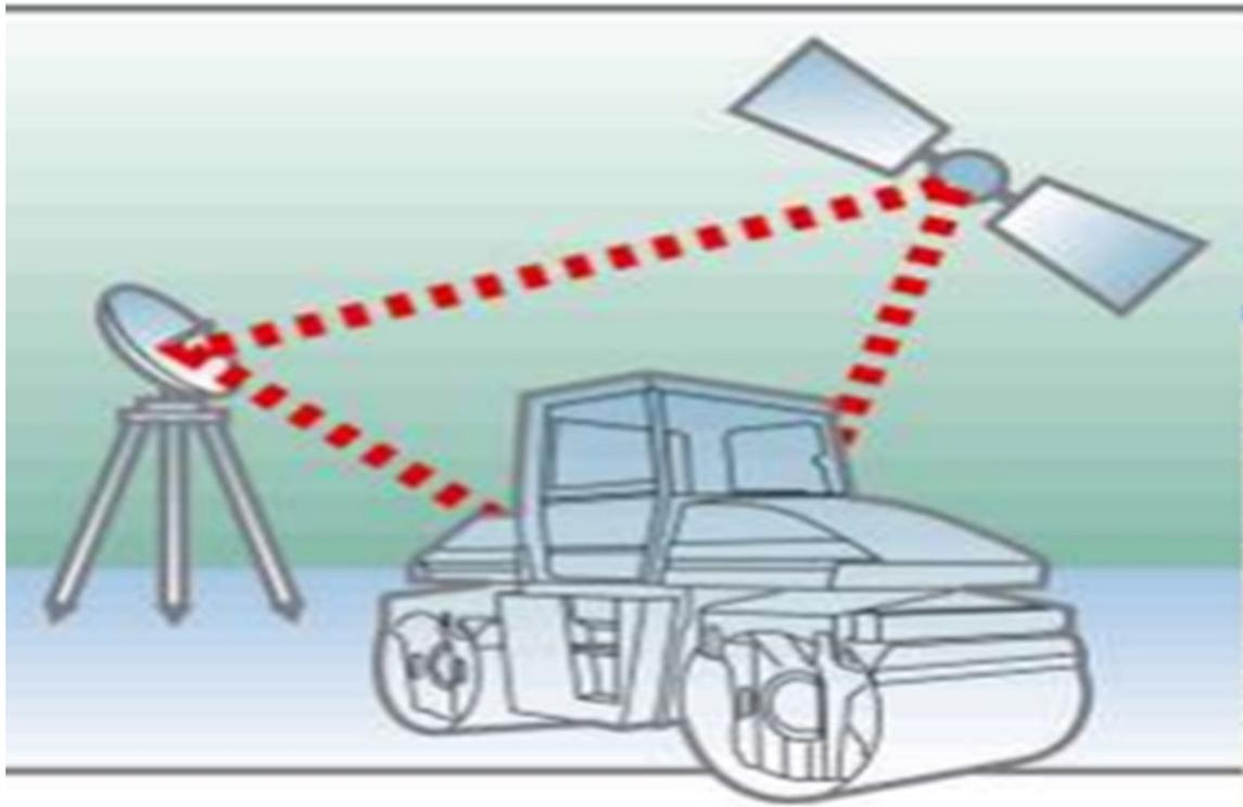
Fig. IV.1.2 Esquema de funcionamiento posicional satélite, receptor, compactador.
