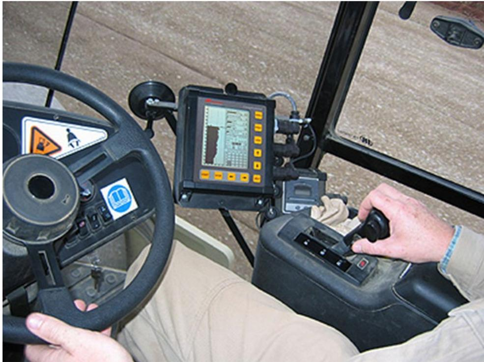
Fig. III.1.1 Interior de la cabina del compactador HAMM.
