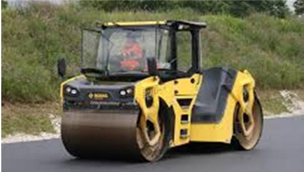
Fig. II.2.10 Compactador doble rodillo BOMAG.
