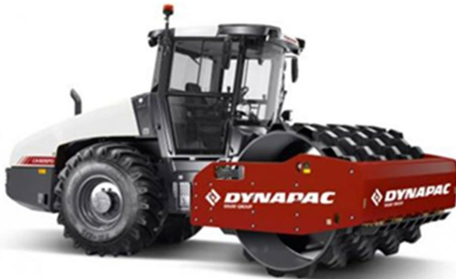
Fig. III.4.3 Rodillo pata de cabra DYNAPAC
