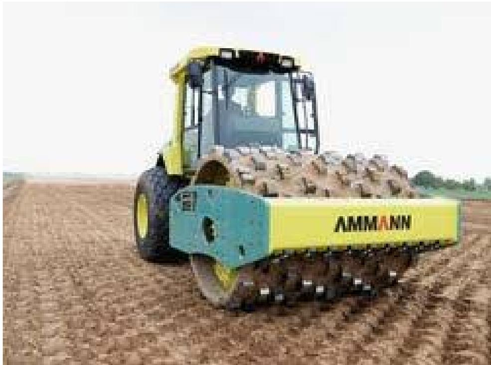
Fig. III.5.4 Compactador AMMANN pata de cabra.
