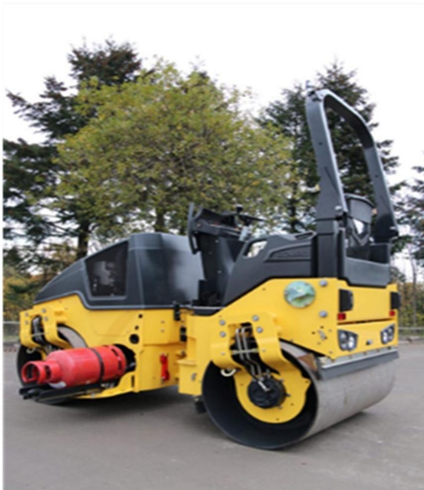
Fig. IV.3.1 Compactador en tándem con Motor de GAS
