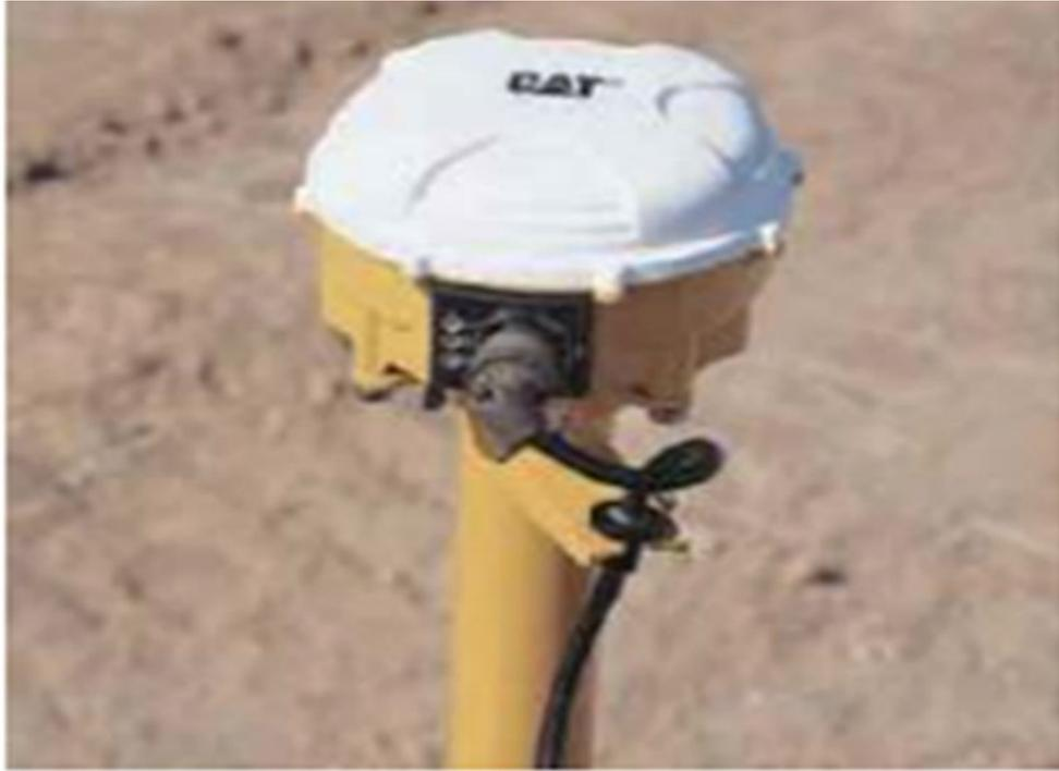
Fig.III.6.6 Receptor GPS en un rodillo Caterpillar.
