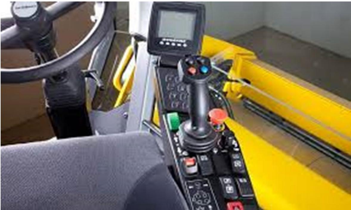
Fig.III.4.1 Interior de la cabina del compactador DYNAPAC.
