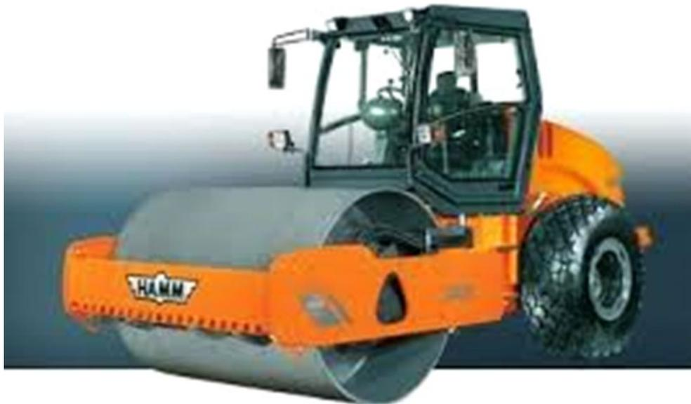
Fig. II.2.6 Compactador HAMM.
