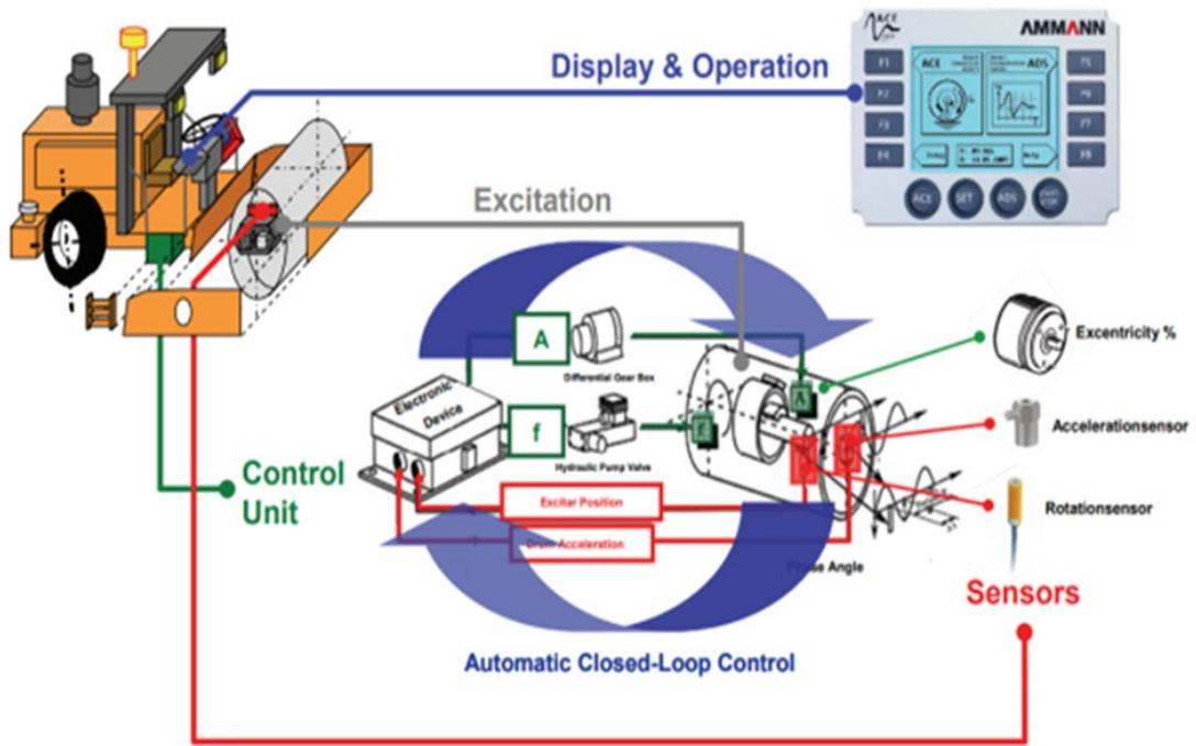
Fig. III.5.2 Sistema de compactación Inteligente de AMMANN.
