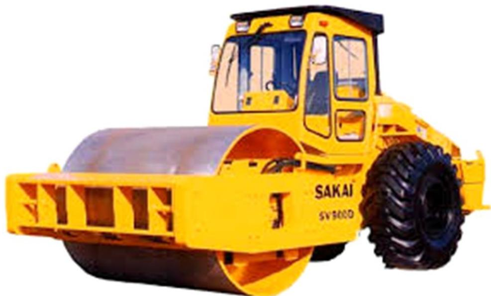
Fig. II.2.5 Compactador rodillo liso SAKAI.
