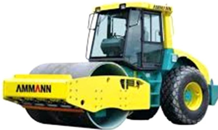
Fig. II.2.1 Compactador rodillo liso AMMANN.
