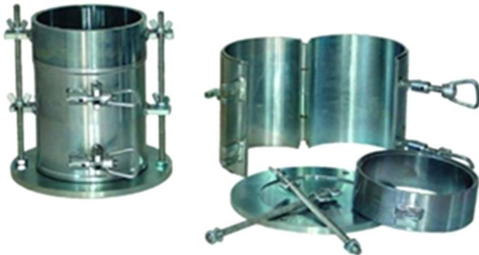
Fig. I.4.1 Cilindros metálicos para la prueba Proctor de laboratorio.
