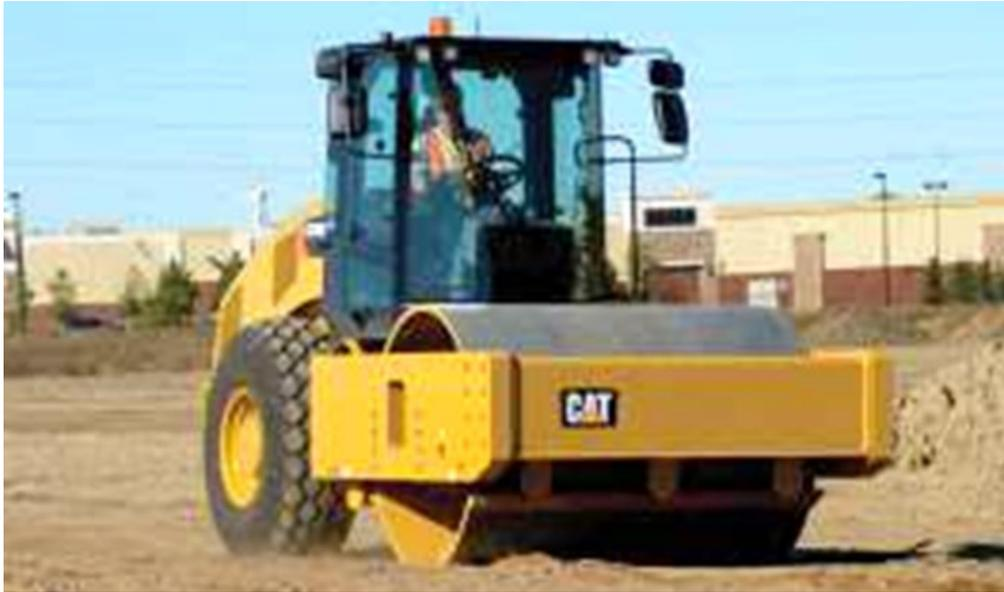
Fig. I.6.1. Compactación con rodillo liso vibratorio.
