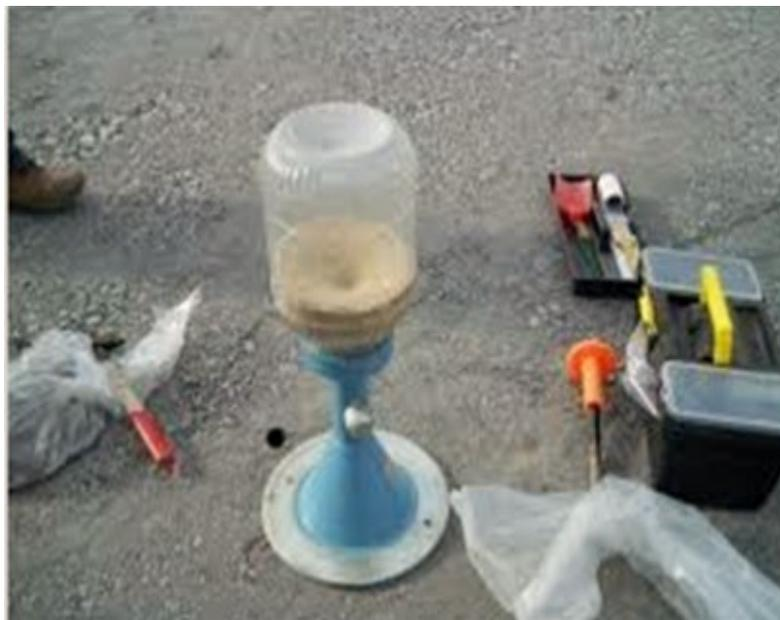
Fig. IV.4.1 Cono de arena para la prueba in situ.
