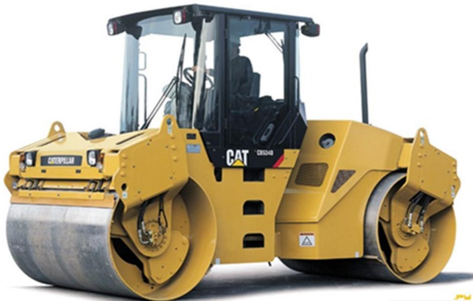
Fig. III.6.4 Compactador en tándem para mezclas asfálticas.
