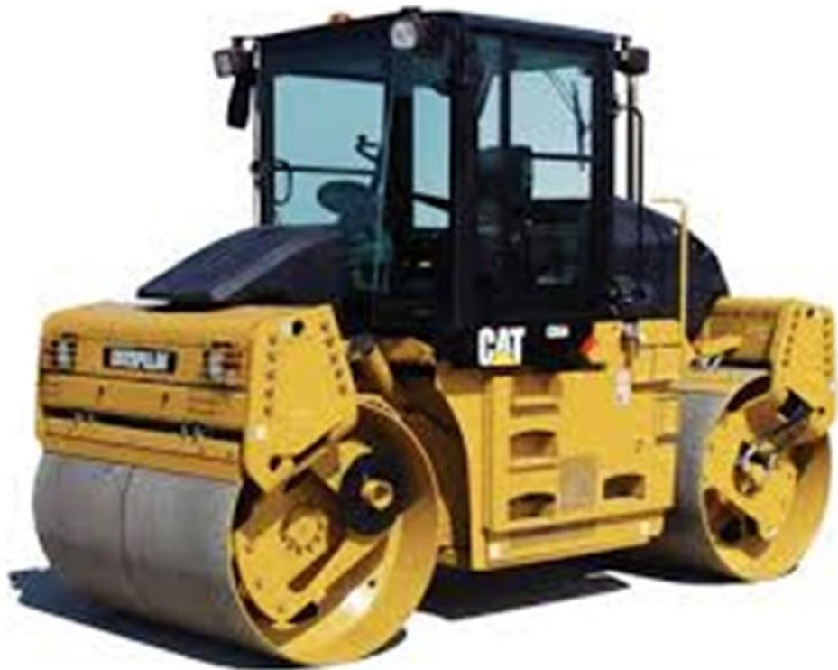
Fig. II.2.8 Compactador CATERPILLAR doble rodillo.
