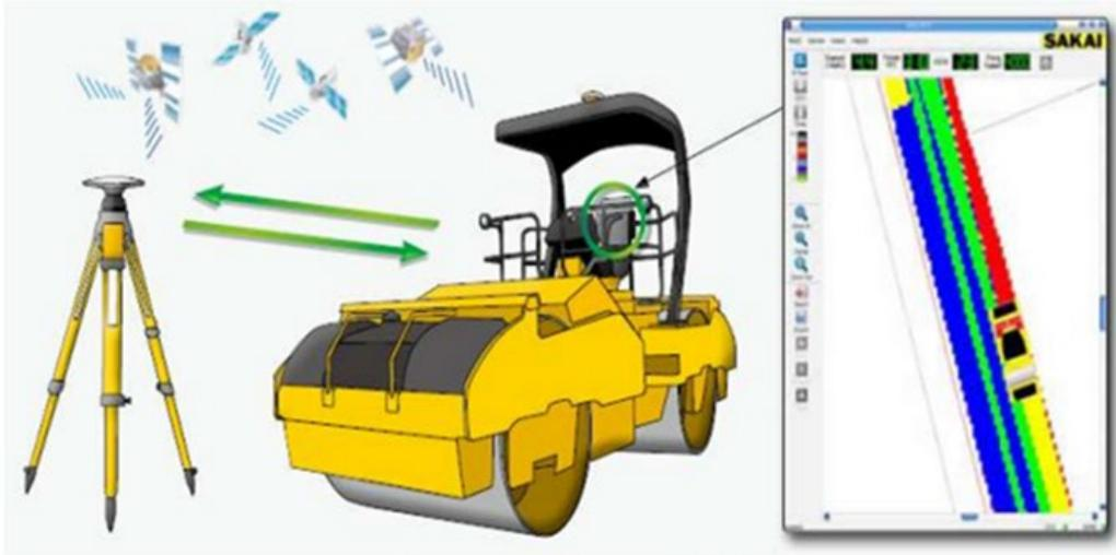
Fig.III.3.1 Esquema de Compactacion Inteligente de SAKAI.
