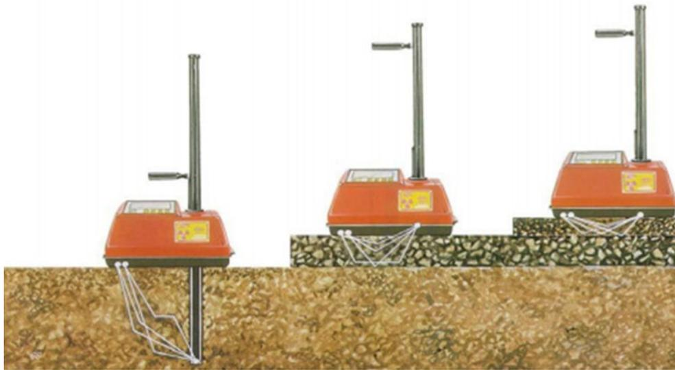
Fig. IV.4.2 Vista de perfil del Densímetro Nuclear
