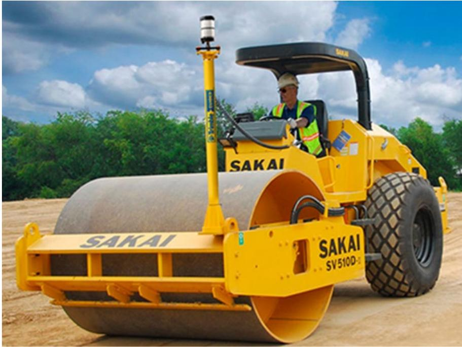
Fig. III.3.3 Compactador SAKAI con sistema GPS.
