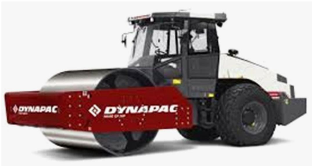
Fig. II.2.3 Compactador rodillo liso DYNAPAC.
