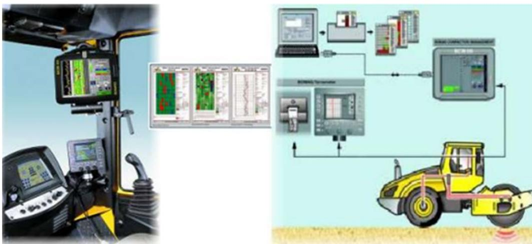
Fig. III.2.3 Esquema de compactacion inteligente en un rodillo BOMAG.
