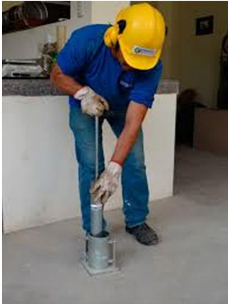
Fig.I.4.2 Prueba Proctor en laboratorio
