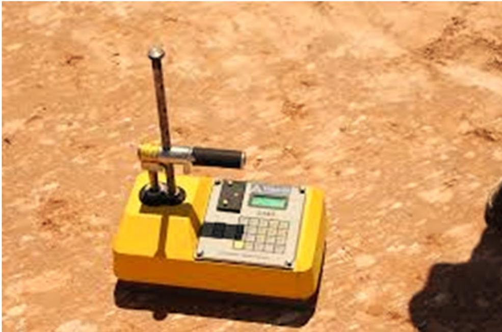
Fig. IV.4.3 Vista en planta del Densímetro Nuclear.
