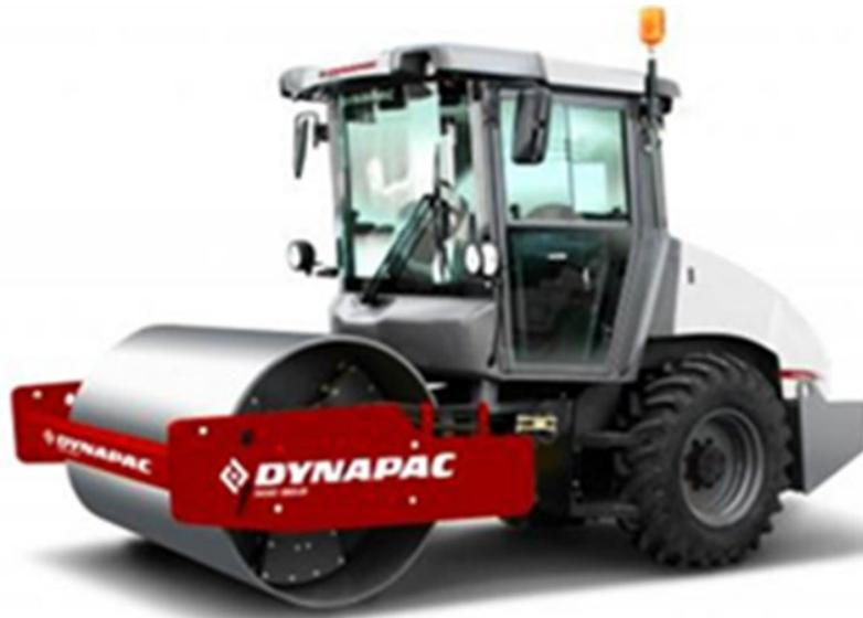
Fig. III.4.2 Compactador rodillo liso DYNAPAC.
