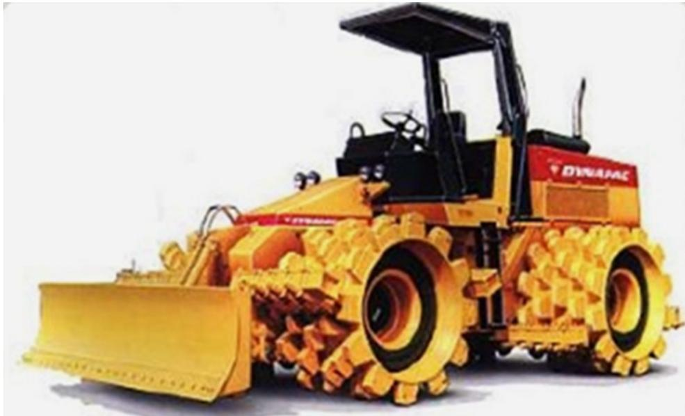
Fig. III.4.4 Compactador pata de cabra IC de alta velocidad DYNAPAC.
