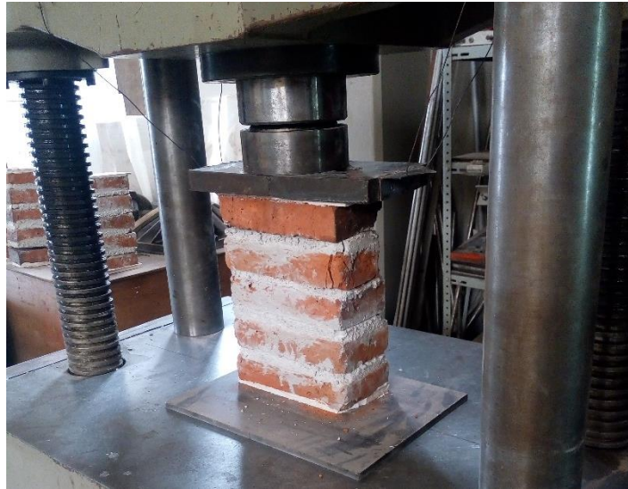
Figura 3.12. Prueba a compresión de pila de mampostería.
