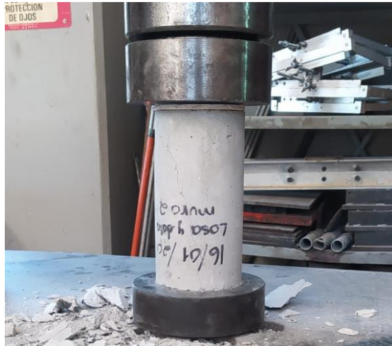
Figura 3.17. Pruebas de compresión a probetas de concreto.
