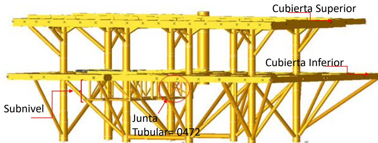
Figura 4.22. Ubicación de la junta tubular más esforzada.
