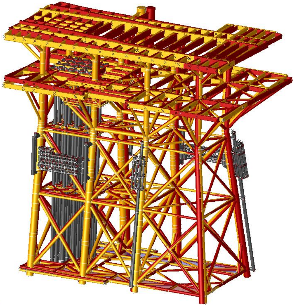
Figura 4.1 Modo de Vibrar 1 de la Estructura.
