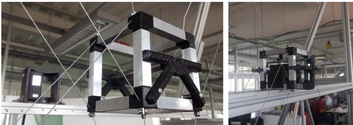
Figura 1. Espacio de trabajo en el arreglo cableado
