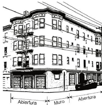
Figura 2.15 Ejemplificación de qué se considera "apertura" y qué no para el análisis de planta baja débil (ATC, 2010).
