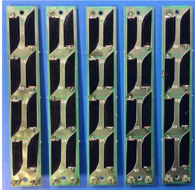
Figura 55. Paneles Solares de KuauhtliSat terminados.
