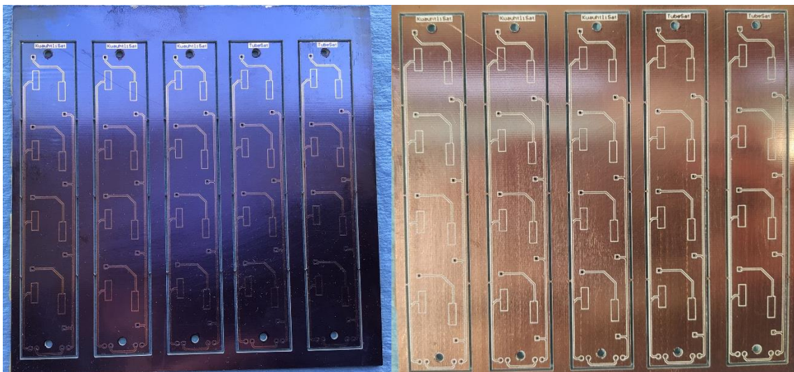
Figura 51. Placa fenólica cubierta de una película fotosensible y con el circuito ya transferido (izquierda) y placa después del ataque químico (derecha).
