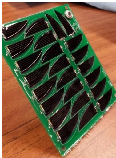
Figura 9. Panel Solar de EquiSat con 24 celdas TrisolX
