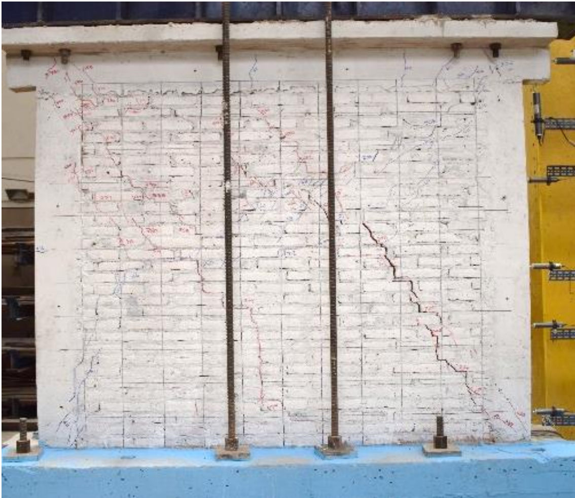
Figura 4.40. Estado final del muro 5.
