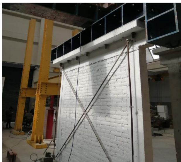
b. Guías metálicas para medir desplazamientos.
