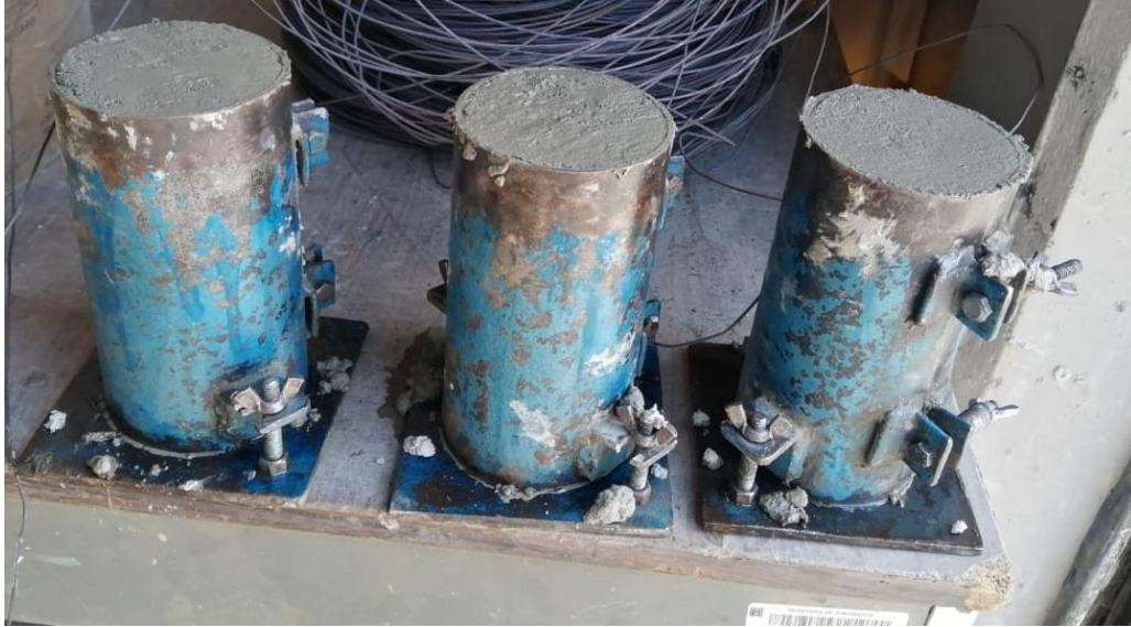
Figura 3.4. Cilindros de concreto para compresión axial.
