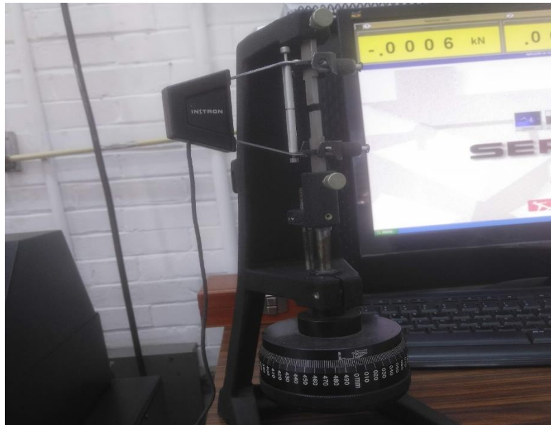
Imagen 99. Calibración del extensómetro.
