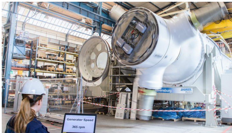
Figura 2.6. Prueba del funcionamiento de una de las turbinas para el proyecto MeyGen,[20].
