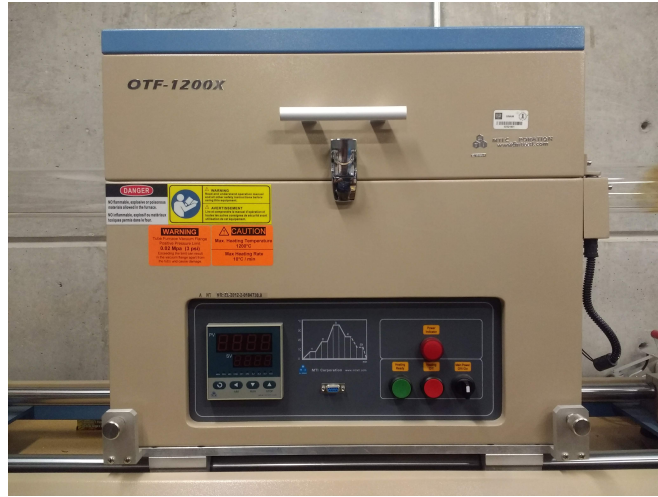
Figura A.5: Fotografía de horno OTF-1200X-80-SL de MTI Corporation. Imagen tomada de la literatura [69].
