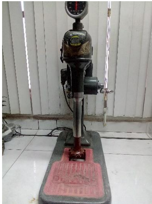
Figura 17. Mecanismo de celda de flotación Denver.
