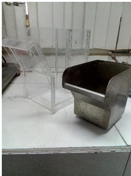
Figura 18. Celdas de flotación 1 y 5 L.
