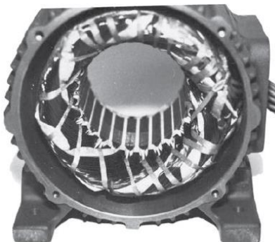
Figura 3.4 Estator de un motor de inducción típico que muestra los devanados del estator. [12]
