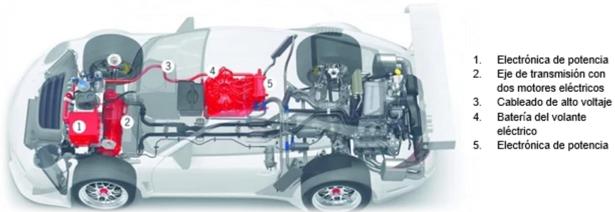
Figura 2.4 Sistema KERS. Audi R18 e-tron Quattro. [8]
