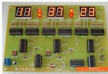
Figura 1. Aplicación de compuertas lógicas en reloj digital, <https://es.aliexpress.com/w/wholesale-electronic-clock-circuit.html>
