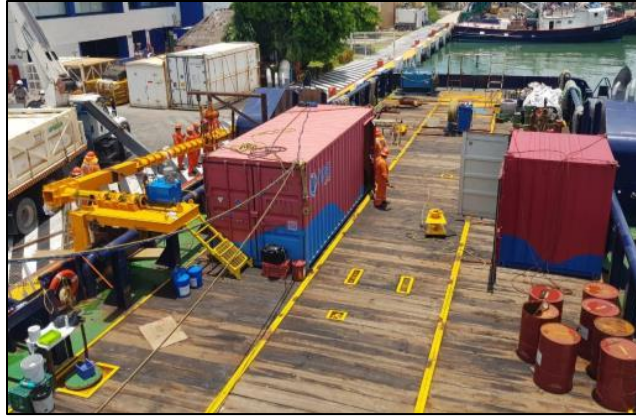
Figura 5. Movilización de la embarcación en el puerto de la Ciudad del Carmen, se pueden observar los dos contenedores de trabajo y el poste de lado de estribor donde se instalaron los equipos de adquisición. Fotografía propiedad de HPS Offshore Services.
