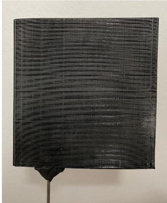
*Figura 17. Perfil NACA 2408 impreso en 3D.*
