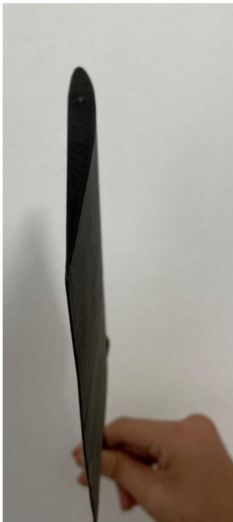
*Figura 18. Perfil NACA 2408 impreso en 3D.*
