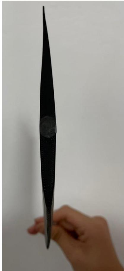
*Figura 16. Perfil NACA 0006 impreso en 3D.*
