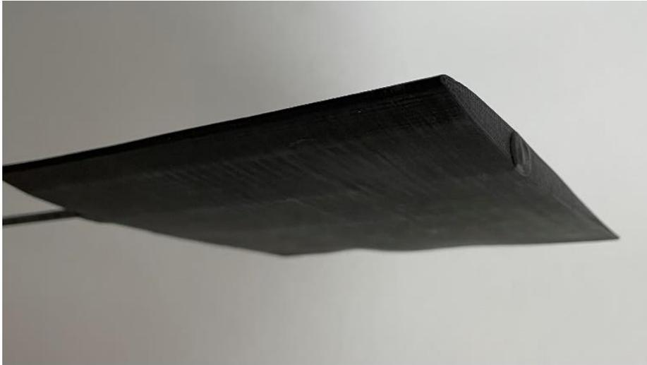
*Figura 15. Perfil NACA 0006 impreso en 3D.*
