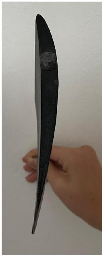
*Figura 22. Perfil NACA 6409 impreso en 3D.*
