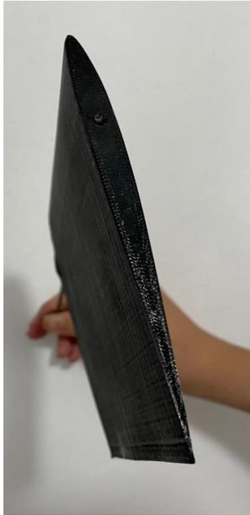
*Figura 19. Perfil NACA 2408 impreso en 3D.*
