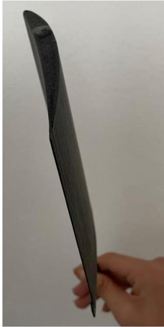
*Figura 21. Perfil NACA 6409 impreso en 3D.*
