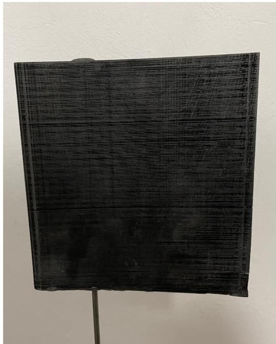
*Figura 20. Perfil NACA 6409 impreso en 3D.*
