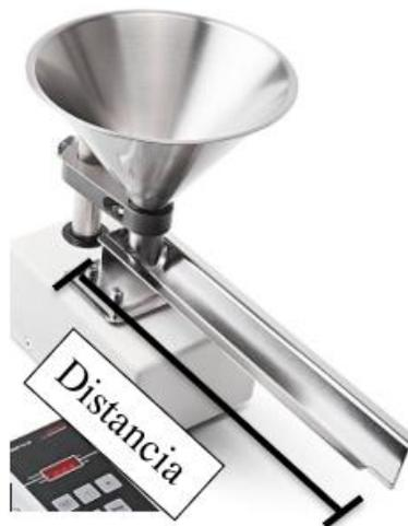
*Fig. 7.3 Imagen alimentador vibratorio*
