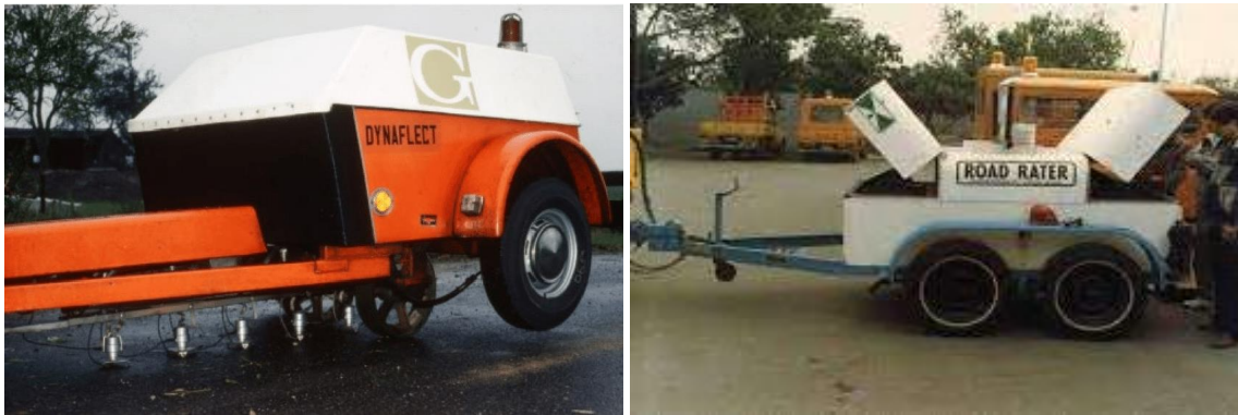
ILUSTRACIÓN 3 EQUIPO DINÁMICO DE APLICACIÓN DE CARGA. FUENTE: INTERNET
