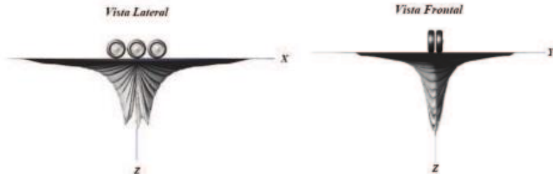
ILUSTRACIÓN 5 EFECTO DE LLANTAS EN ARREGLO TRÍDEM; FUENTE: (HIGUERA C. H., 2008)
