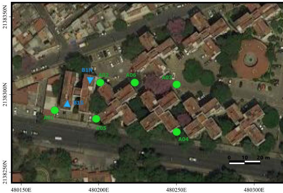
Figura 5.19: Localización de las estaciones para registro de vibración ambiental. Color verde: tomadas a nivel de piso. Color azul: tomadas en la azotea del edificio B1.
