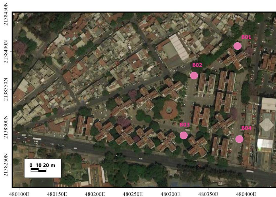
Figura 5.26: Localización de las estaciones de la segunda campaña para registro de vibración ambiental (puntos color rosa).
