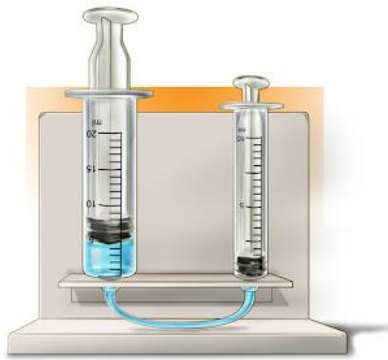
Figura 17. Sistema hidráulico con émbolos [18].
