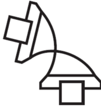
Figura 20. Pivote de flexión transversal [20].
