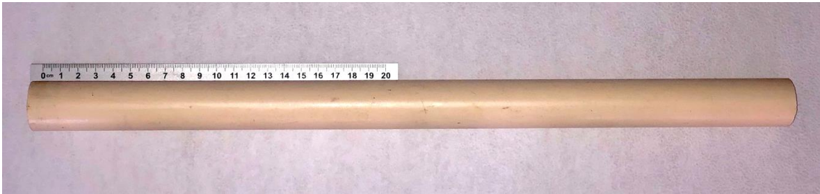
Figura 3.4 Carcasa del prototipo del LVDT (CPVC 1”).
