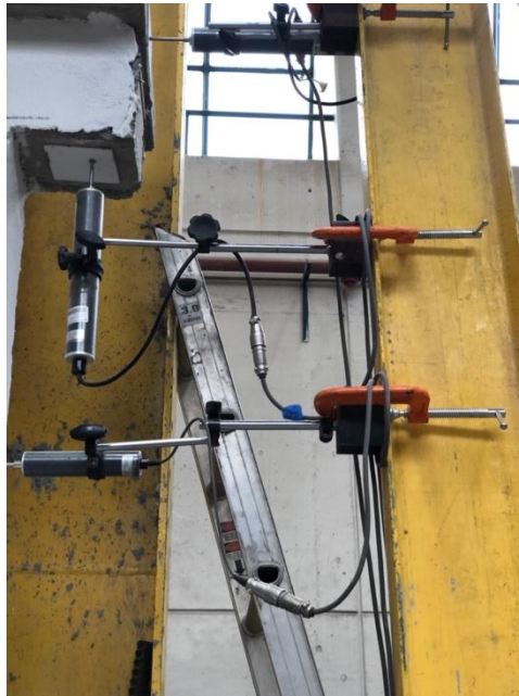
Figura 4.5 Instrumentación de espécimen de prueba con sensores CDP.
