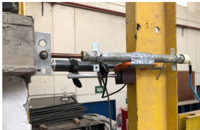
Figura 4.6 Prototipo LVDT colocado en paralelo a un CDP.
