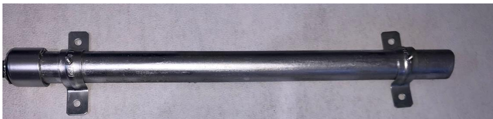
Figura 3.16 Soportes anclados a la carcasa del LVDT.
