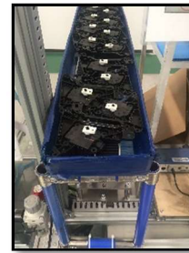
Figura 7. Actualmente se abastece sub ensamblado el motor actuador en su bracket.
