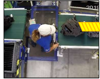
Figura 9. La operadora únicamente presiona el escáner y la pieza es leída.
