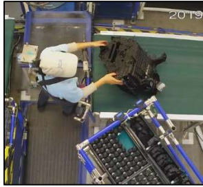
Figura 8. La operadora tiene que ajustar la pieza y tomar el escáner para poder leer la pieza
