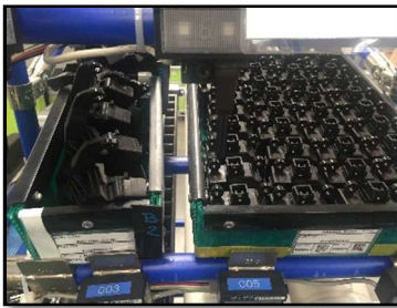
Figura 6. Anteriormente el abasto de motor actuador y bracket era en dos cajas por separado.
