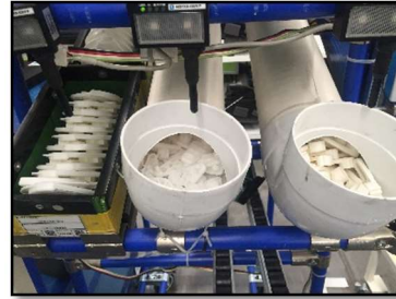
Figura 5. Ahora el abasto es en tubos lo que facilita la toma del material
