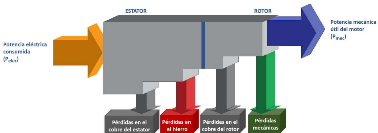
Figura 2.31 Interpretación de la potencia consumida y potencia mecánica útil del motor
