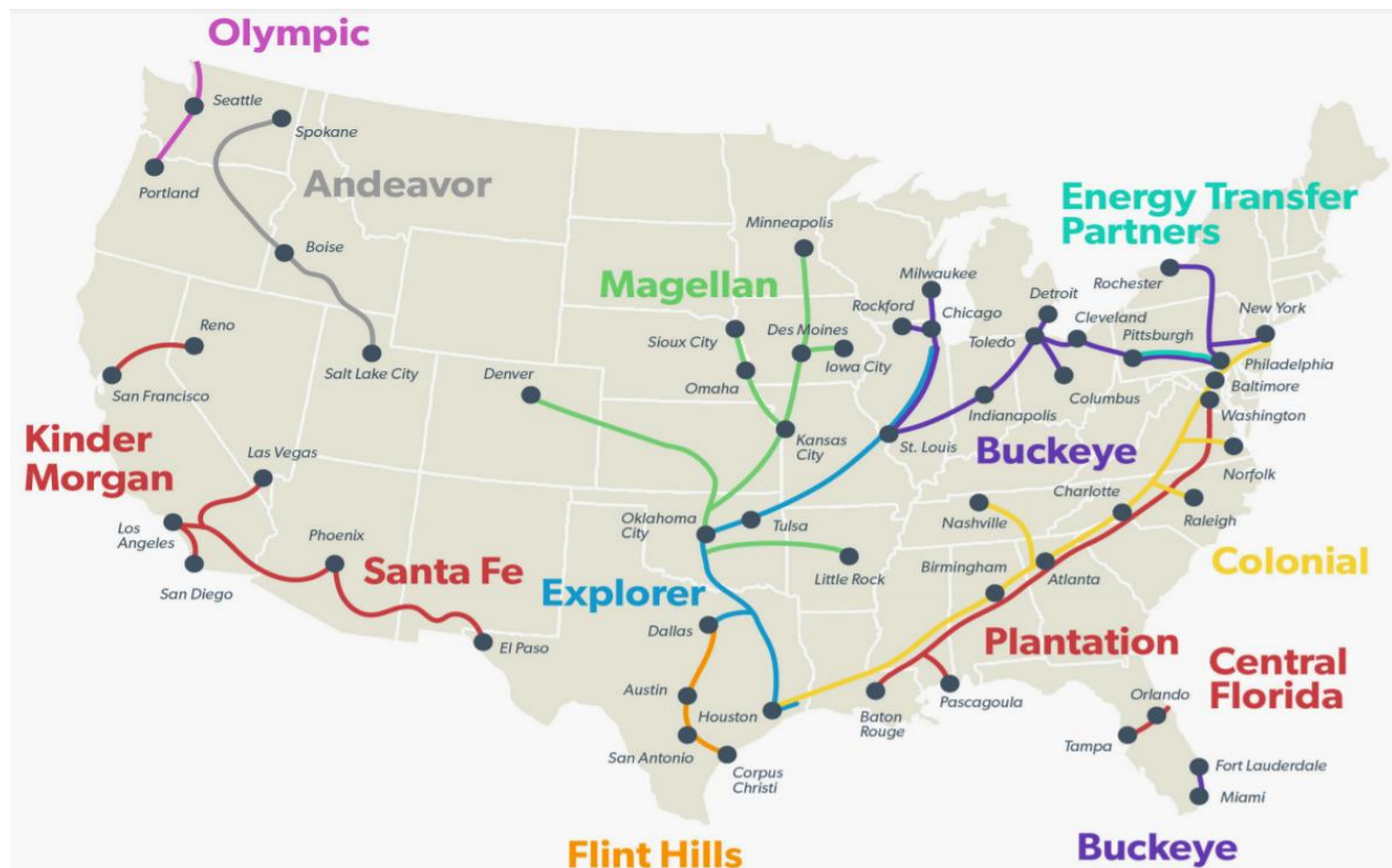
Figura 2.1 Red de ductos para el transporte de Jet fuel en EUA, (Airlines for America, 2016). 10
