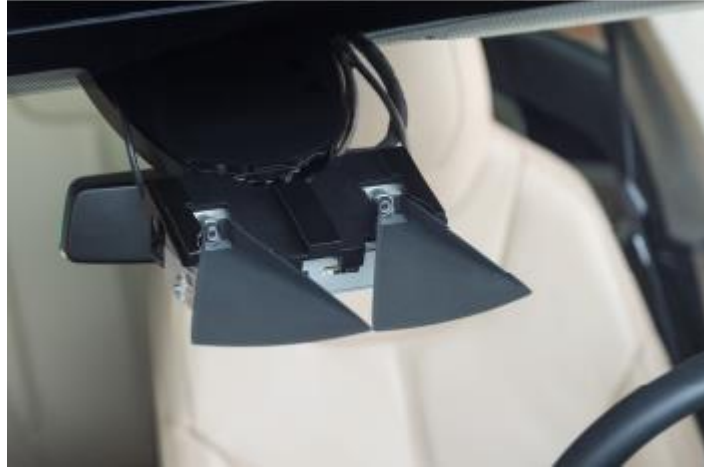
Figura 2.6.4.1. Cámara montada en el espejo retrovisor [15]
