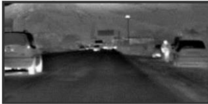
Figura 2.4.4.1. Imagen producida por una cámara FIR [23]
