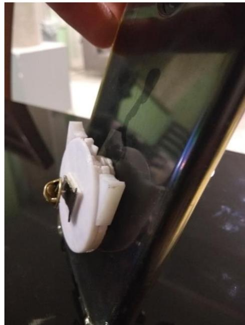
*Fig. 38. Eslabón asegurado dentro del encapsulado*
