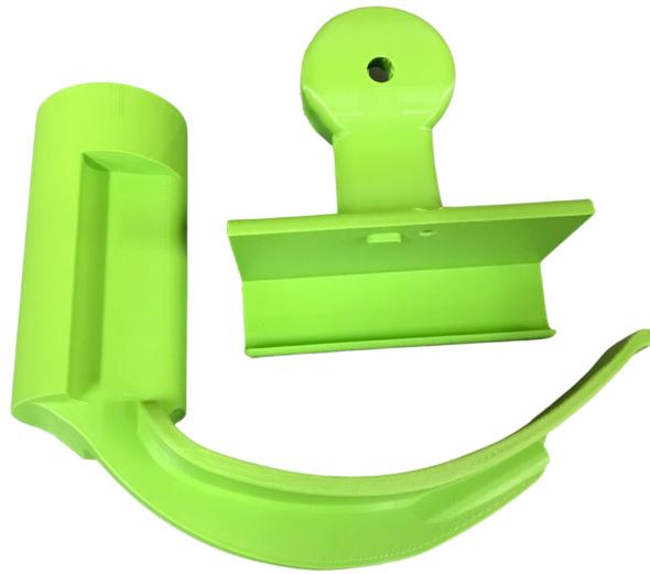
Figura 5.17: Fotografía del modelo impreso con PLActive color verde después del postproceso.
