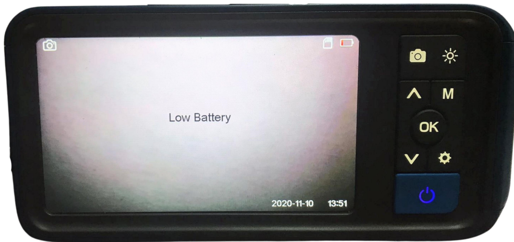
Figura 5.24: Fotografía de la pantalla Teslong donde se muestra la advertencia de batería baja.
