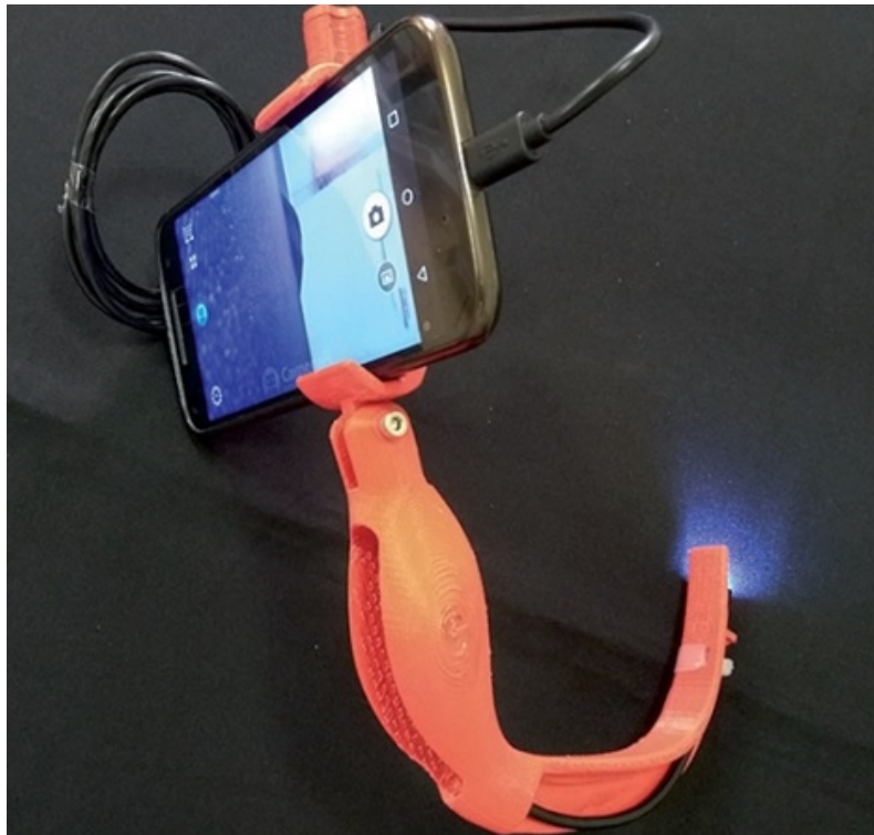
Figura 3.6: Videolaringscopio de bajo costo con soporte ajustable creado en el Hospital de Niños de la Santísima Trinidad en Córdoba, Argentina [14].
