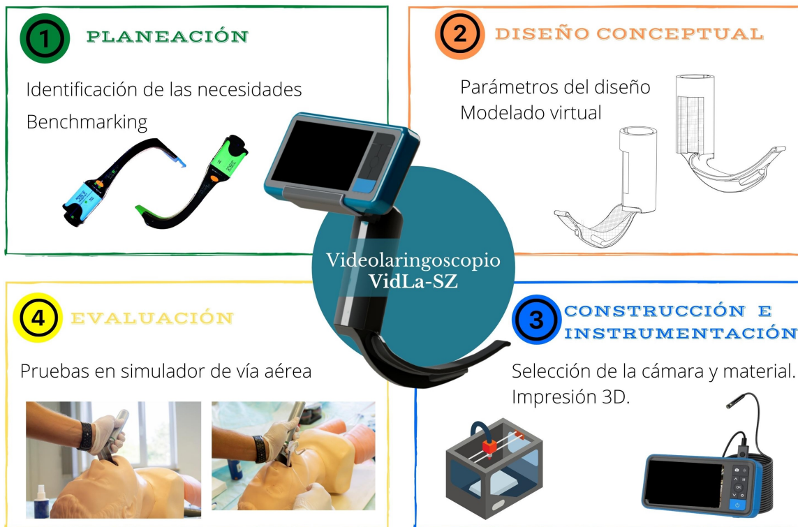
Figura 4.1: Proceso de diseño del videolaringoscopio VidLa-SZ .
