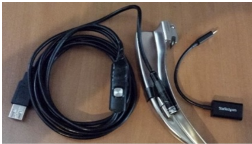
Figura 3.7: Videolaringoscopio artesanal Macintosh realizado en el Hospital General de Zacatecas, México [8].
