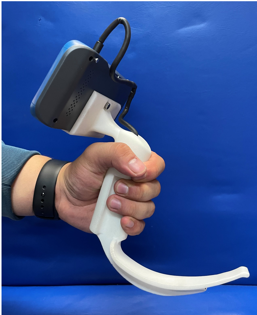
Figura 5.23: Prototipo del VidLa-SZ fabricado mediante SLS con el material Nylon 12.
