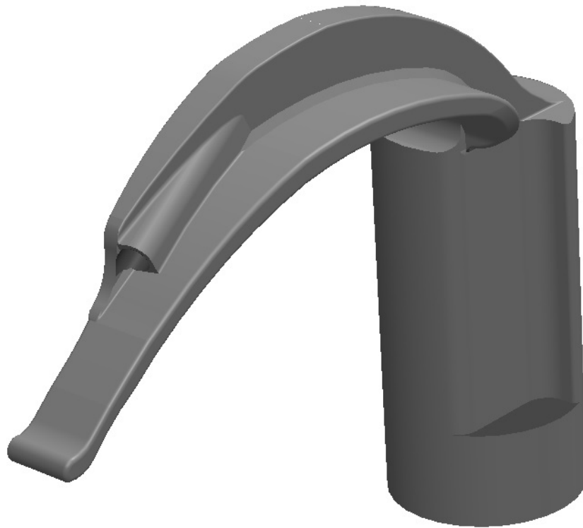
Figura 4.24: Modelado en el software SolidWorks de la hoja propuesta del videolaringoscopio VidLa-SZ .
