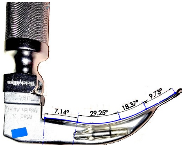
Figura 4.3: Medidas del ángulo del laringoscopio con hoja Macintosh No. 3.
