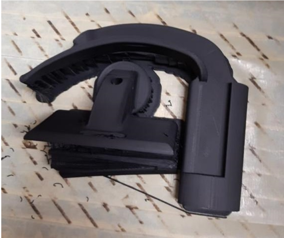
Figura 5.16: Fotografía del modelo recién impreso en 3D sobre la base de la impresora.
