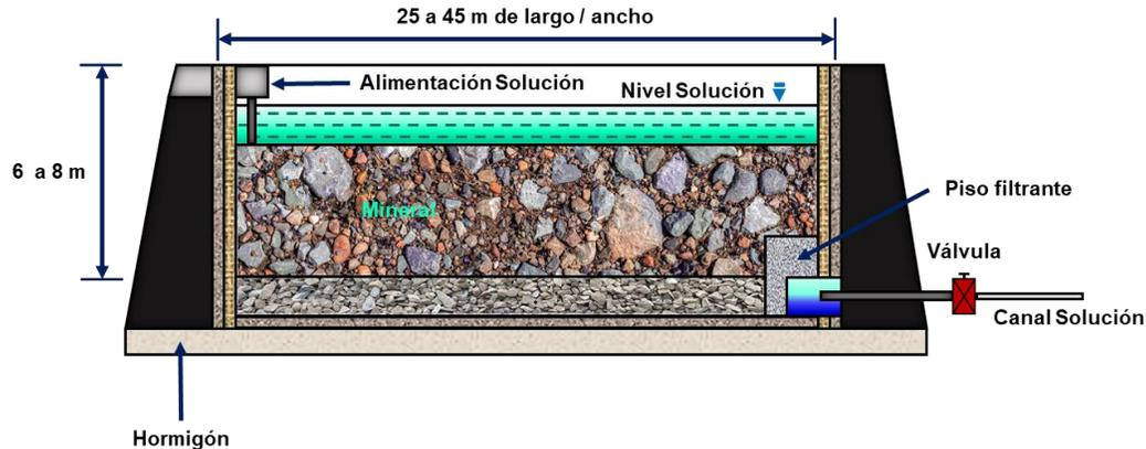
Figura 12: Esquema de corte de un cajón de lixiviación de minerales similar a las que se usaron en Chuquicamata (Domic, 2001).
