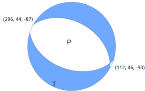
Figura 3.2. Mecanismo de falla calculado por el SSN del sismo del 19 de septiembre de 2017.” La pelota de playa muestra el tipo de falla y la orientación de ésta.
