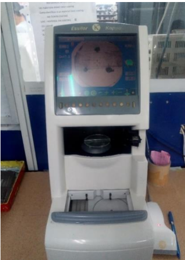
Figura 2.7. Dispositivo que sujeta la lente con un bloque, de manera automática.
