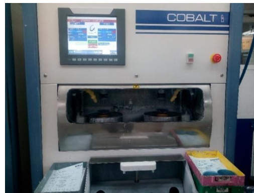
Figura 2.5. Máquina con la que se realiza el proceso de pulido.
