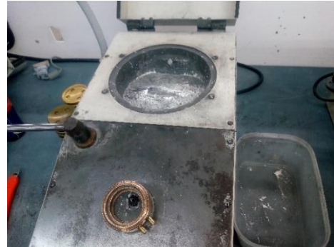
Figura 2.3. Equipo utilizado para inyectar el líquido “aloy”, que adhiere el block a la lente.
