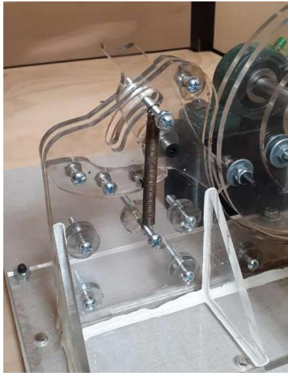
**FIGURA 26. Ensamble de los resortes en el mecanismo.**
