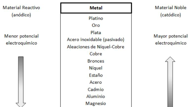
El potencial electroquímico define la susceptibilidad de un material metálico a la corrosión. Cuanto más positivo sea el valor de dicho potencial, más resistente es el material, en el caso contrario cuanto más negativo sea el material sufrirá más corrosión. En la figura 1 se
