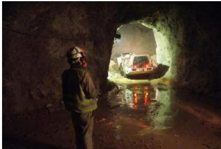
Ilustración 7. Sistema de rezagado a control remoto
