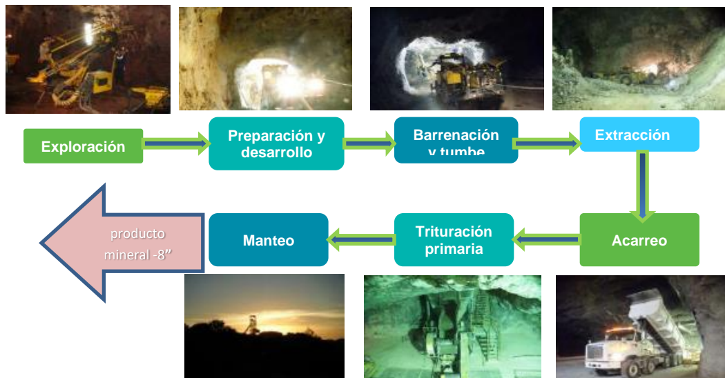
Ilustración 10. Diagrama de flujo del sistema de minado
