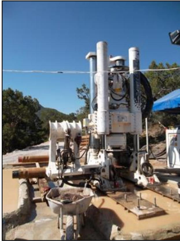
Ilustración 24. Perforación y toma de muestra de lodo
