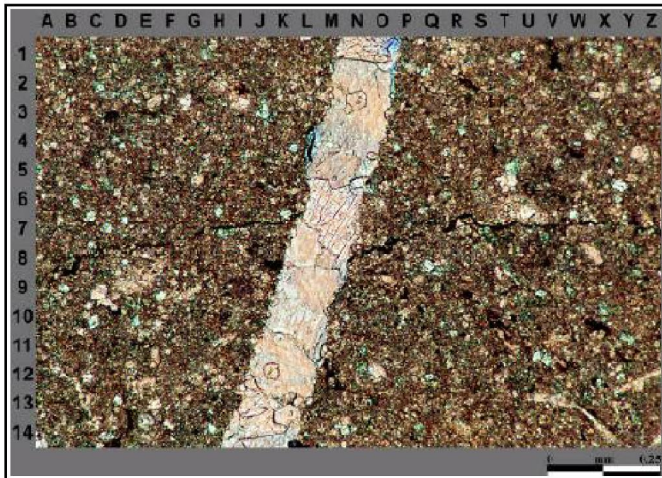
Figura 4-10: Fractura completamente cerrada, en caliza tipo mudstone, Prof. 5626.05m (Laboratorios Agat, 2004)
