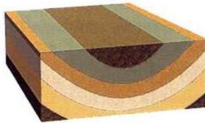
Figura 3-15: Representación de un sinclinal (Micone, 2015)
