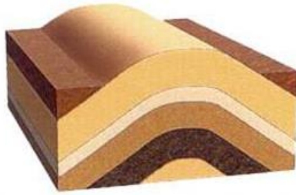
Figura 3-14: Representación de un anticlinal (Micone, 2015)
