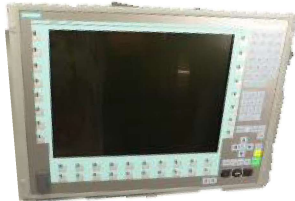
Figura (Abbildung) 4.80 Siemens 677C - Human Machine Interface (HMI)
