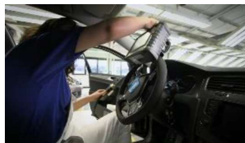
Figura (Abbildung) 4.93 Conexión de MPS por OBD a vehículo (Verbindung mit Fzg.)
