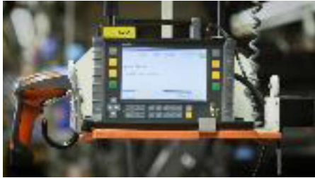
Figura (Abbildung) 4.86 Estación de trabajo móvil (Mobilen Prüfstation, MPS)
