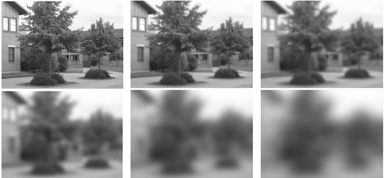
Figura 2.15. Representación del espacio-escala de una imagen con diversos valores de t . De izquierda a derecha y de arriba a abajo, t = 0, 1, 4, 16, 64, 256
