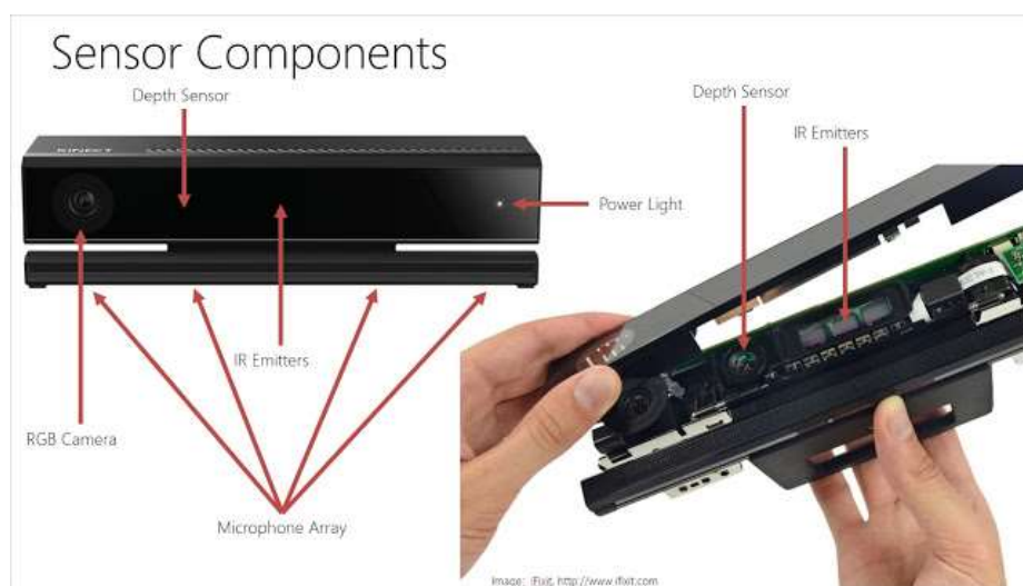
Figura 4.1. Detalles de los componentes del Kinect 2 de Microsoft.
