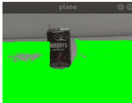
Figura 4.7. Plano detectado con RANSAC
