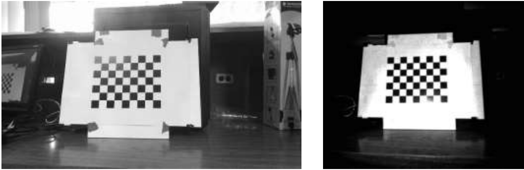
Figura 6.1. Ejemplo de las fotos tomadas al patrón para la calibración. Derecha: Imagen RGB, Izquierda: Imagen Infrarroja
