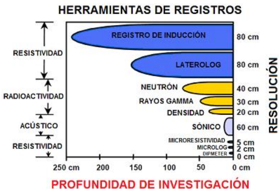
Figura 1.11. Diagrama comparativo de las diferentes herramientas en la toma de registros mostrando las diferentes propiedades físicas, su resolución vertical y la profundidad de investigación con la que trabajan (IMP,2019).
