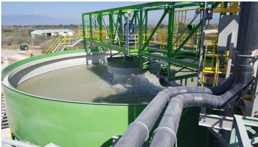
Figura 2.5. Se muestra el espesador de jales Marca FL Smith en proceso de llenado
