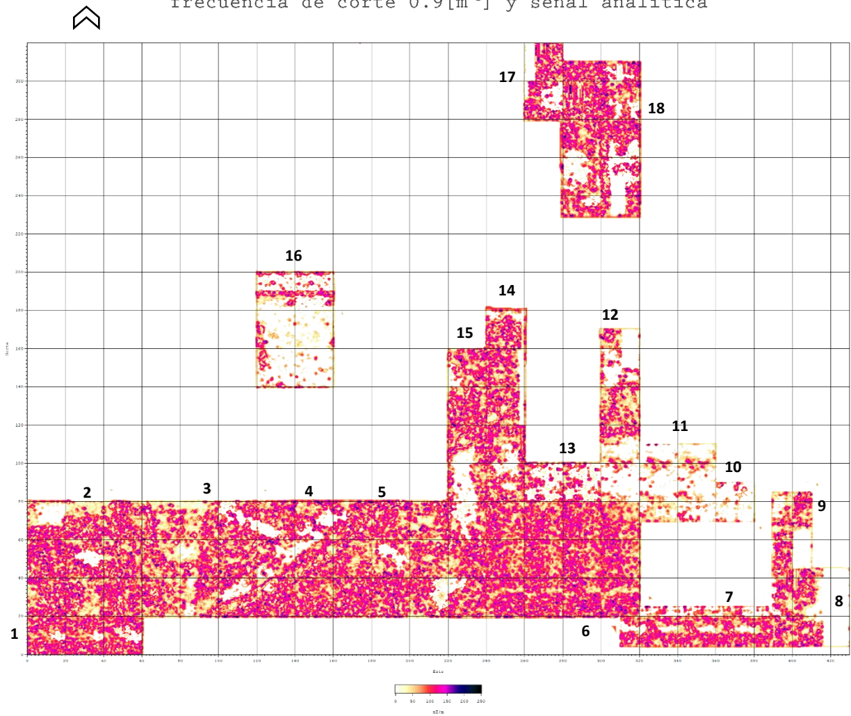
Fig. 60. Mapa de datos de gradiente magnético procesados con filtro Butterworth pasa bajas con frecuencia de corte 0.9[m^{-1}] y amplitud de la señal analítica en el cuadrante N2E1 en la zona arqueológica de Teotihuacan.
