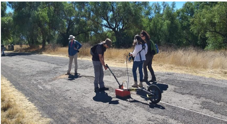
Fig. 47. Levantamiento de Georradar en la zona asfaltada del Cuadrante Norte dos Este uno de Teotihuacan.
