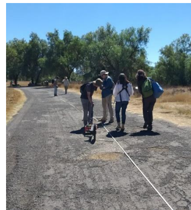
Fig. 47. Levantamiento de Georradar en la zona asfaltada del Cuadrante Norte dos Este uno de Teotihuacan.
