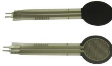
Figura 16. FSR 400 Resistencia de detección de fuerza, serie redonda. (ELECTRONICS, 2010)
