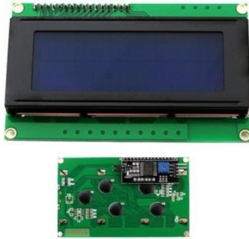
Figura 14. Pantalla LCD 20x4 de aplicación. ( https://solectroshop.com , s.f.)
