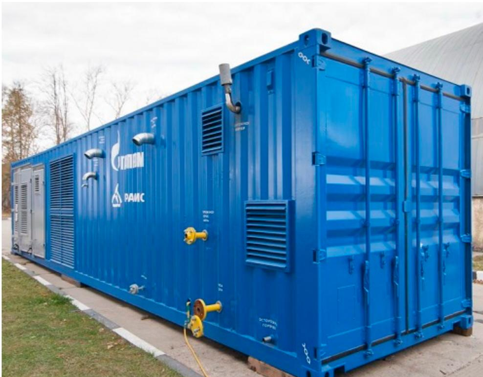
**Figura 25.** Unidad generadora de nitrógeno (CJSC GRASYS, 2015)
