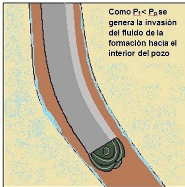
**Figura 22.** Perforación bajo balance
