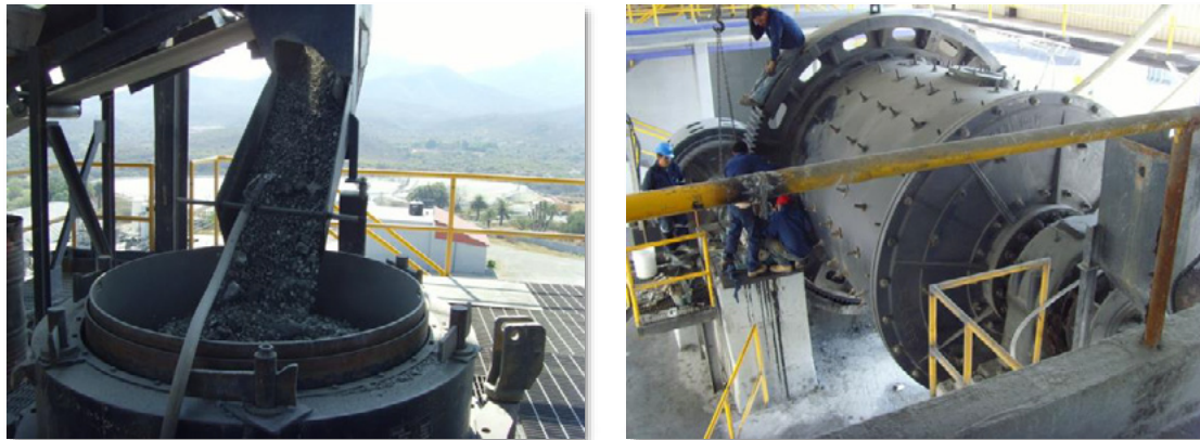
Figura 1.6 Trituración de la mena (izquierda) y molienda en molino de bolas (derecha). Cortesía de Compañía Minera y Beneficiadora Purísima, S de R. L., Zimapán, Hidalgo.
