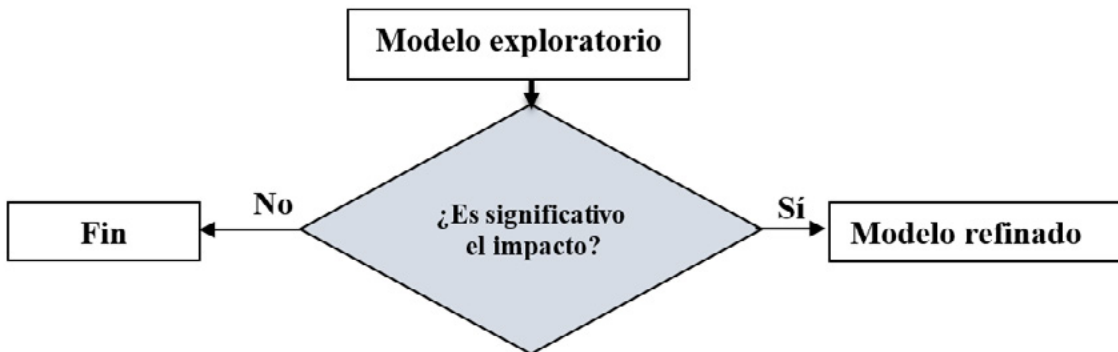
Figura 4.18. Elementos del proceso de simulación para la evaluación de impactos a la calidad del aire provocados por fuentes específicas. El modelo exploratorio permite ahorrar tiempo y recursos económicos significativos
