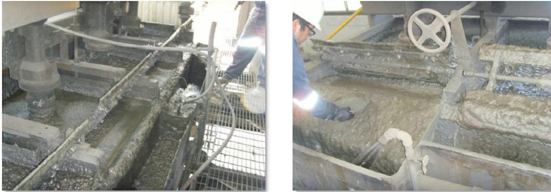
Figura 1.7 Circuito de flotación. En la fotografía de la derecha, el sobrenadante es el zinc que se desea obtener y se precipitan residuos minerales. Cortesía de Compañía Minera y Beneficiadora Purísima, S de R. L., Zimapán, Hidalgo.
