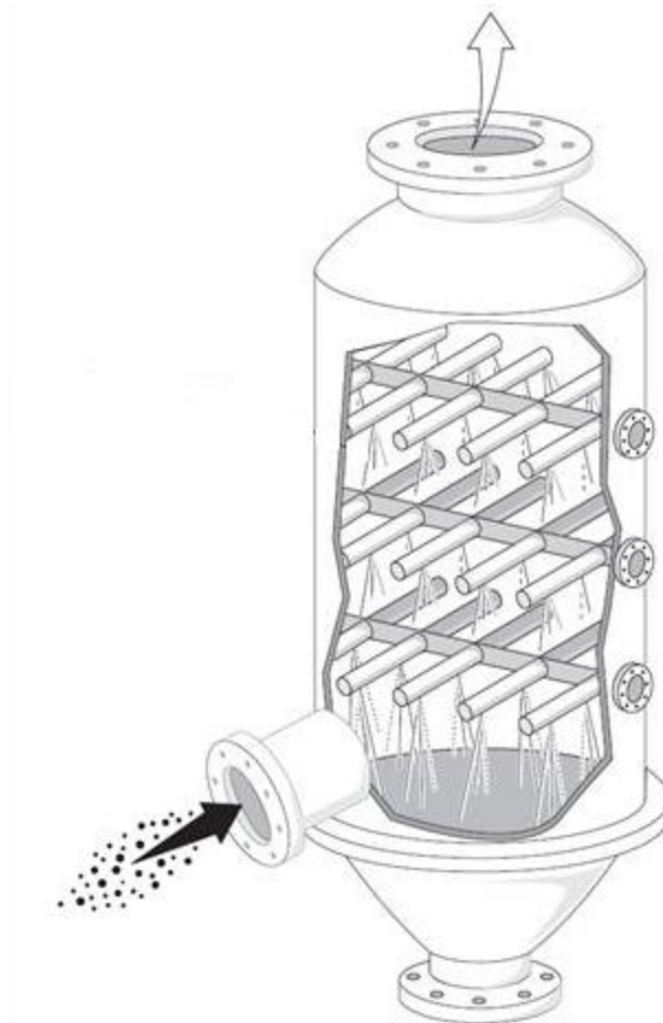
Figura 4.28. Torre de aspersión. Las fuerzas inerciales y centrífuga actúan para separar las partículas de la corriente gaseosa
