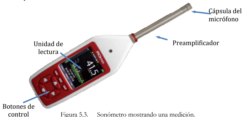
Figura 5.3. Sonómetro mostrando una medición.
