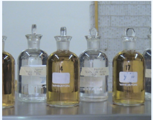
Muestras iniciales con oxígeno disuelto fijado (amarillas) y muestras diluidas para introducirse a la incubadora (transparentes)
