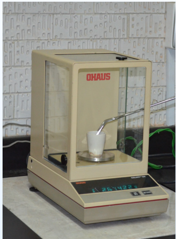
Figura 1.8 Algunas etapas de la determinación de sólidos. La prueba se centra en determinar mediante diferencia de pesos el material contenido en un crisol o una cápsula de porcelana que se encuentre en la muestra analizada
