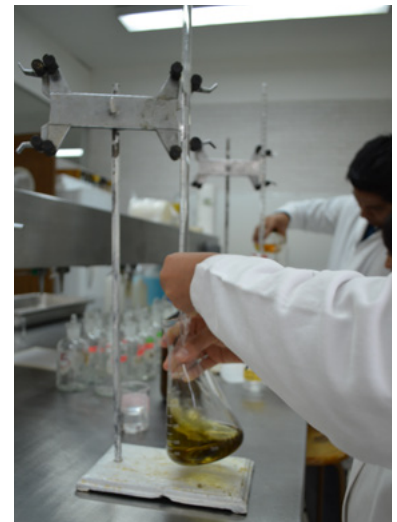
Figura 1.9 Titulación para la determinación de oxígeno disuelto durante la prueba de DBO
