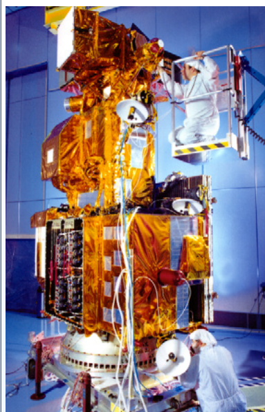
Figura 3.5 LANDSAT 7 La plataforma LANDSAT 7 posee un sensor ETM+ (Enhanced Thematic Mapper Plus), con características adecuadas para el estudio de cuerpos de agua
