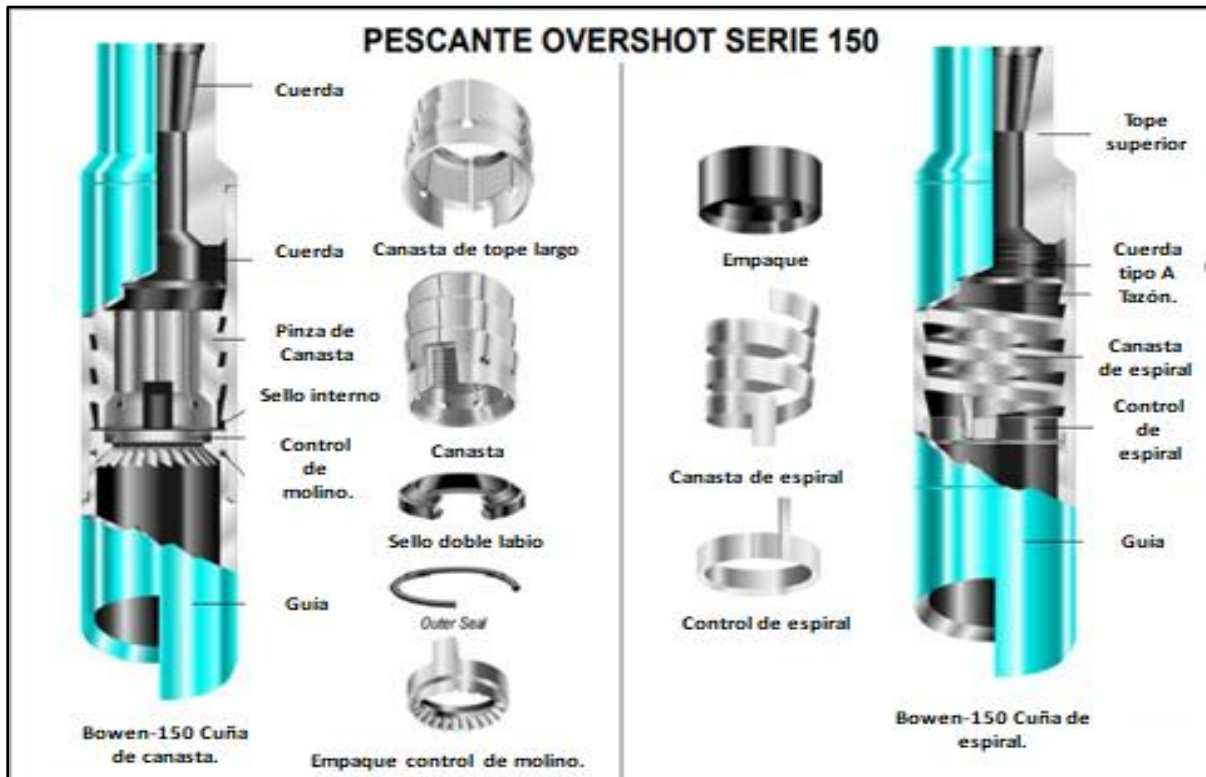
Imagen 49 Over Shot 150 Canasta - Over Shot 150 Espiral, Weatherford.
