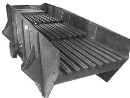
Figura 3. 11-3 Criba vibratoria de tres escalones. Tomado de Metso ( Mining Screens ).
