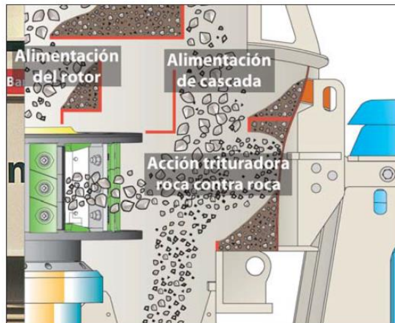
Figura 3.5-61 Mecanismo de trituración de los equipos VSI. Adaptado de Metso Minerals (2013).
