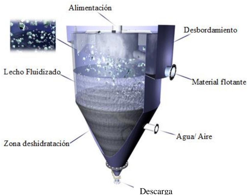
Figura 4. 3-79 Esquema del separador Hydrofloat. Adaptado de Eriez (Flotation Division).
