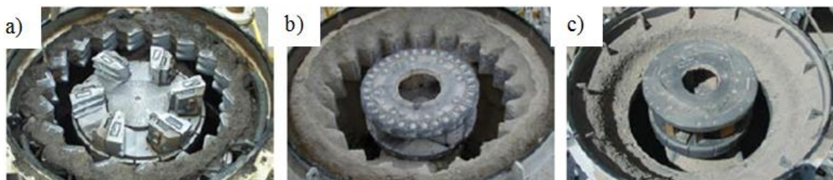
Figura 3.5-71 Configuraciones de la VSI Canica. Leyendas: a) Placa sobre yunque, b) Roca sobre yunque y c) Roca sobre roca. Tomado de Terex (2011).
