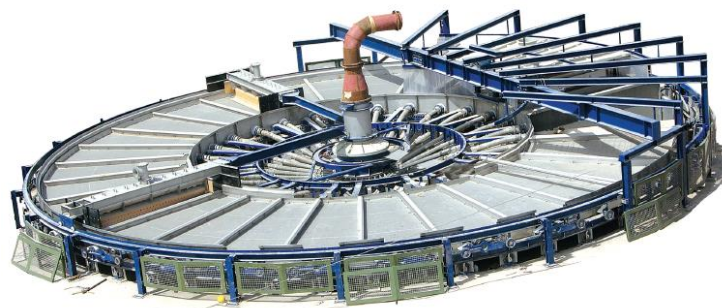
Figura 4.4-41 Vista general de un filtro de bandejas. Tomado de Dunne, Kawatra & Young (2019).
