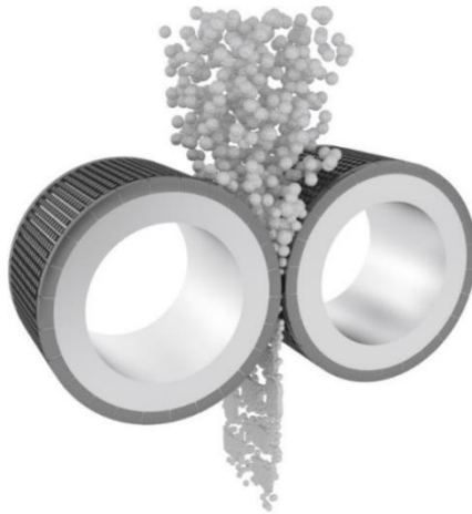
Figura 3.5-47 Mecanismo de trituración de las unidades HPGR. Tomada de HEXADUR “High-Pressure Grinding”
