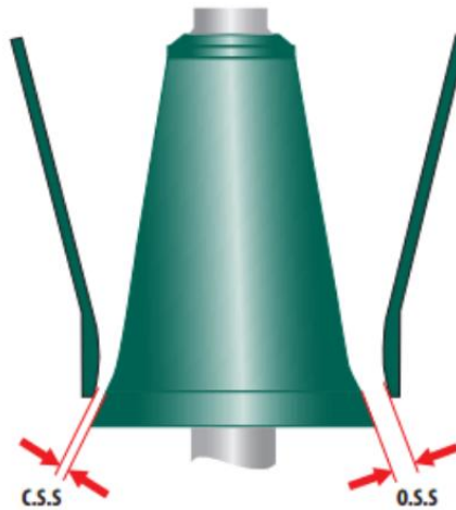
Figura 3.4-37 Esquema de la carrera de una trituradora giratoria. Adaptado de Metso Minerals (2003).
