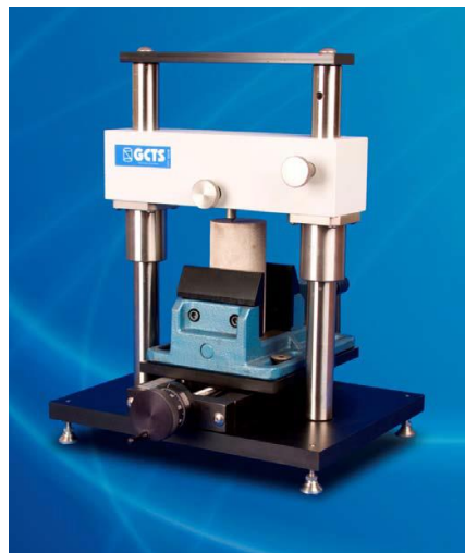
Figura 2. 3-2 Aparato de abrasividad de roca (RAA-100). Tomado de GCTS (Testing Systems).
