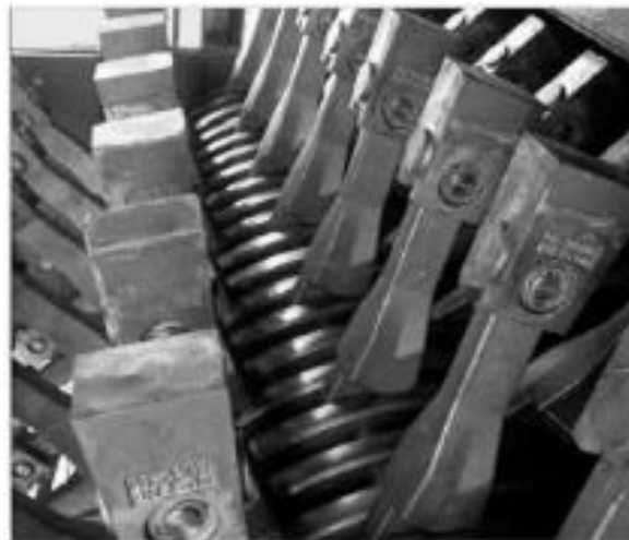
Figura 3.5-63 Barras y yunques de un molino de martillos de cabeza en "T". Tomado de Wills y Finch (2016).
