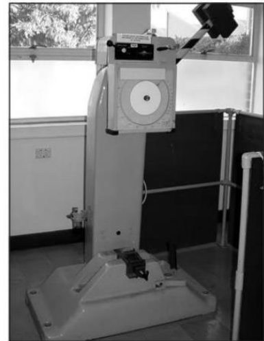
Figura 2. 3-1 Equipo del índice de abrasión por contacto directo. Tomado de Dunne, Kawatra y Young (2019).
