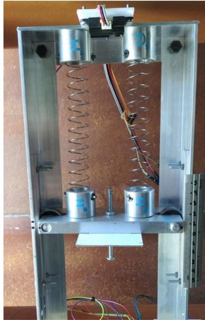
Figura 4.32: Configuración del prototipo m-r-r-a para obtener la respuesta libre.
